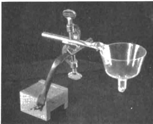
4 a. Bilden visar den skål, i regel av plast, i vilken isotopen placeras vid vissa undersökningar. Skålen hålls i regel på plats med en anordning, bestående av klena rörstycken, klover och en magnet.
