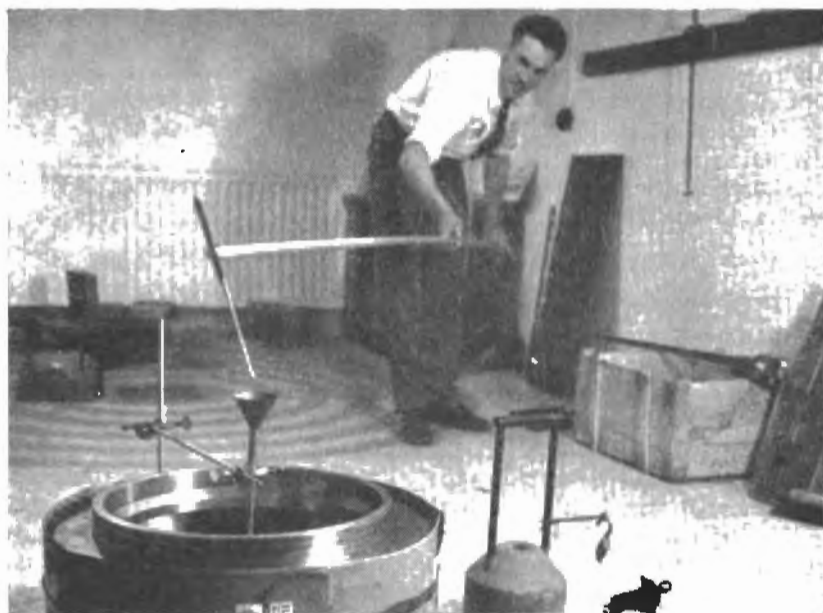
Bild 6. Typisk bild av uppställning för gammardiografering. Isotopen nedföres via tratten i den anordning, som är festsatt i centrumlinjen av den maskindetalj, som skall undersökas. Runt maskindetaljen är den film anbringad, på vilken ev felaktigheter i materialet registreras.
