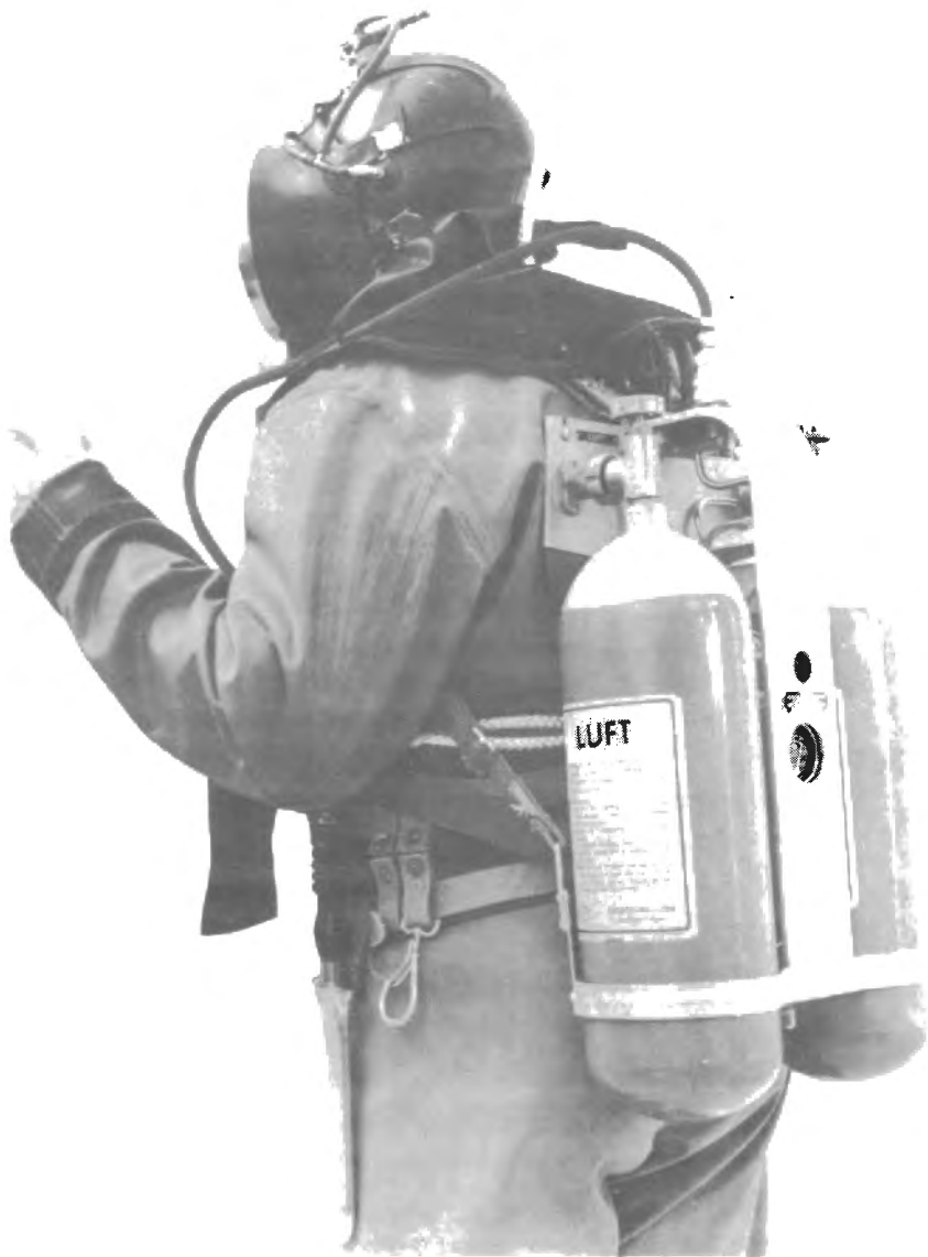
Bild 6. Dykare med annan typ av svensk andningsapparat. Telefonlinan används här även som signallina.
