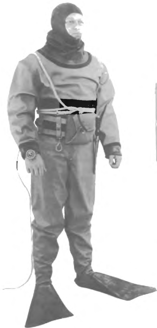
Bild 3. Gummidräkt, midjebälte, simfenor, väska för avvägningstyngder, kniv, djupmätare och livlina påtagna.
