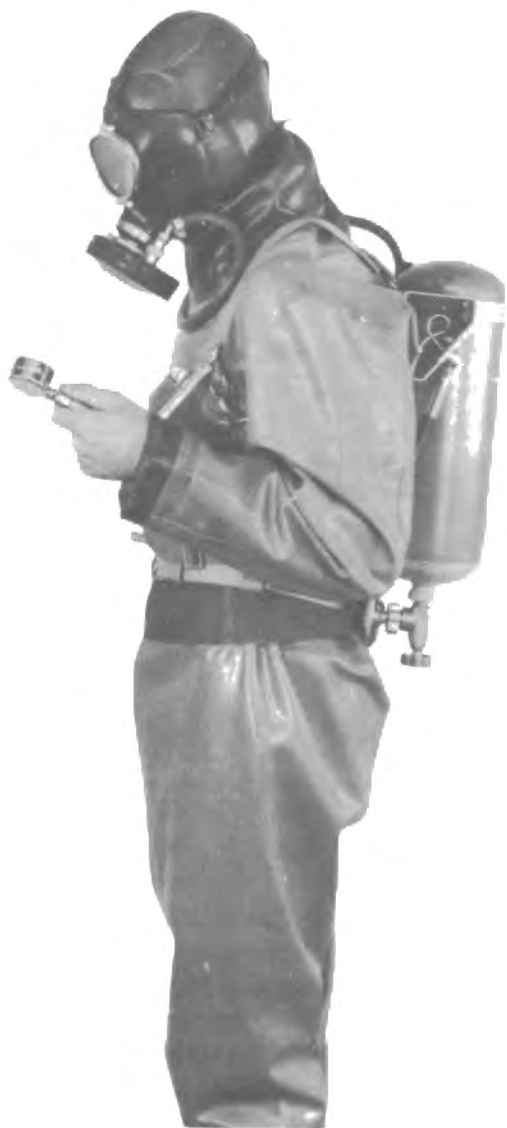
Bild 5. Dykare med svensk andningsapparat och ansiktsmask av typ, som även används för rökdykning.
