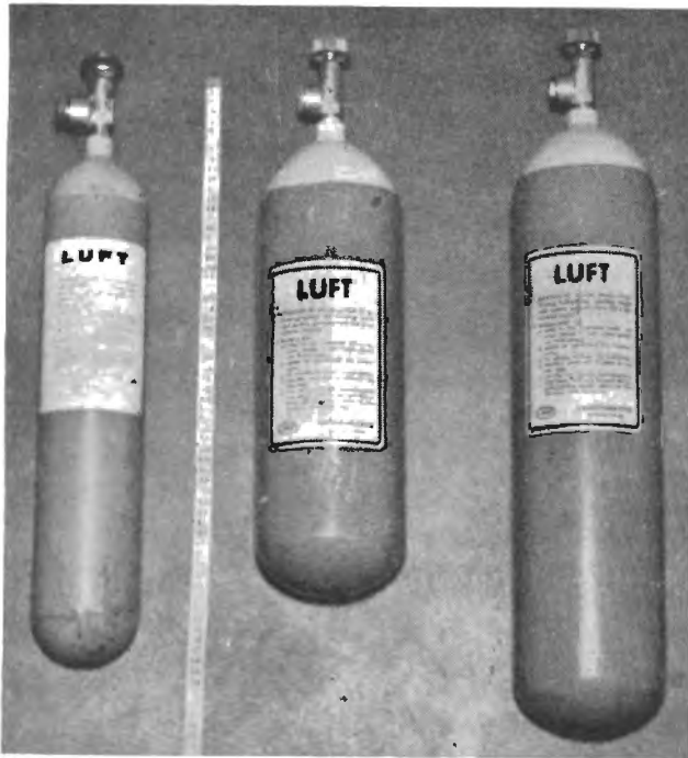
Bild 7. Luftbehållare av de vanligaste storlekarna, från vänster 3-liters, 5-liters och 7-liters. 3-litersbehållaren är här försedd med en tysk ventil, 5- och 7-litersbehållarna med svenska ventiler.
