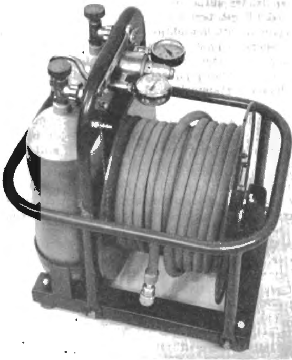
Bild 6. Exempel på utrustning för luftförsörjning på avstånd, »extraluft genom slang».
