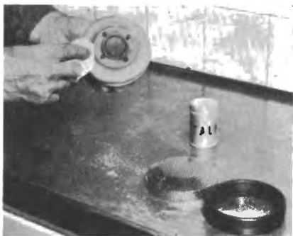
Bild 26. Innan andningsdosan monteras ihop masseras membranet med litet talk, och kontroll verkställs att utandningsventilen inte fastnar.
