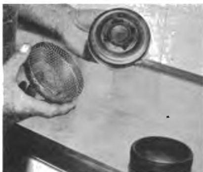
Bild 24. Andningsdosans skyddsring och skyddsgaller monteras av.
