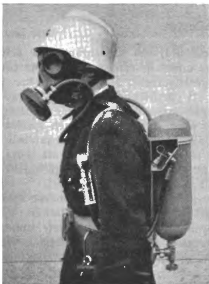
Bild 1. Svensk tryckluftapparat, Aga-Divator Universal I, med 5-liters behållare och för bäraren synlig manometer.
