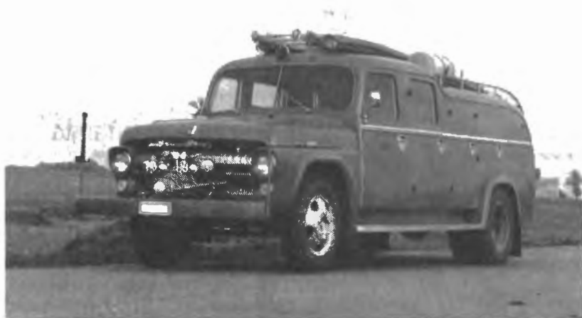
Bild 13. Exempel på tankbil typ T 2. Tankbil typ T 2 kan med fördel även utföras med personalhytten helt skild från materielutrymmet. Det är då lämpligt att till personalutrymme använda seriebyggda sk dubbelhytt. Utöiken
