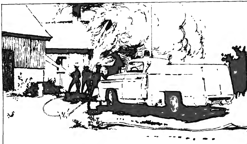
Bild 11 a. Tankbilen används i detta fall på samma sätt som på bild 10 a. Ett grenrör har placerats på brandplatsen och slangutläggning påbörjats mot vattentaget.
