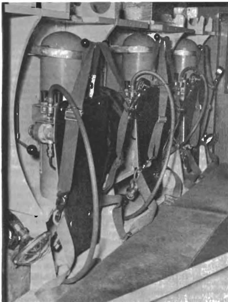
Bild 28. Tryckluftapparater i utryckningsberedskap infällda i ryggstödet i brandbilens hytt.
