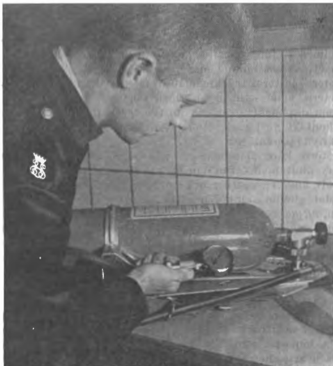
Bild 27. Kontroll av trycket på tryckregulatorns lågtryckssida med hjälp av provningsmanometer.
