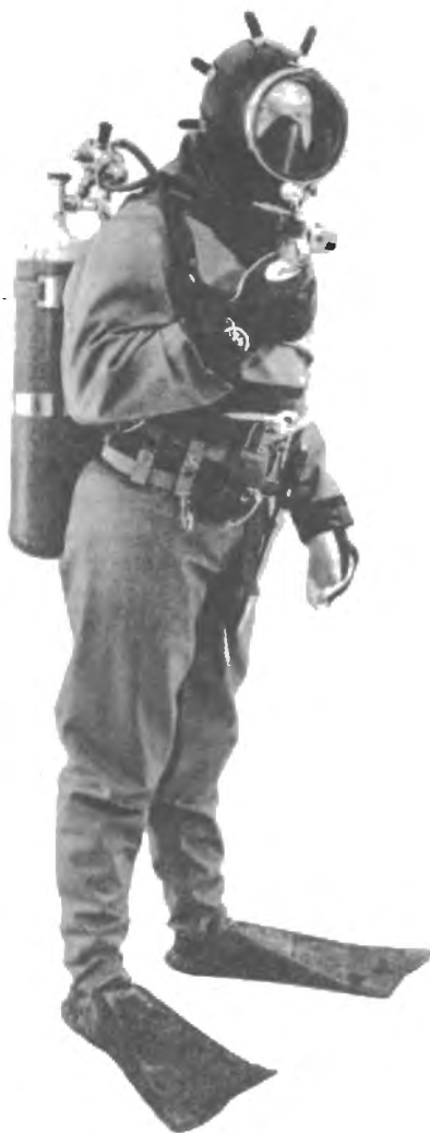
Bild 2. Fullt utrustad dykare, iförd torrdräkt, midjebälte, simfenor, väska för avvagnings-tyngder, kniv, djupmätare, livlina, andningsapparat och ansiktsmask av specialutförande för vattendykning.
