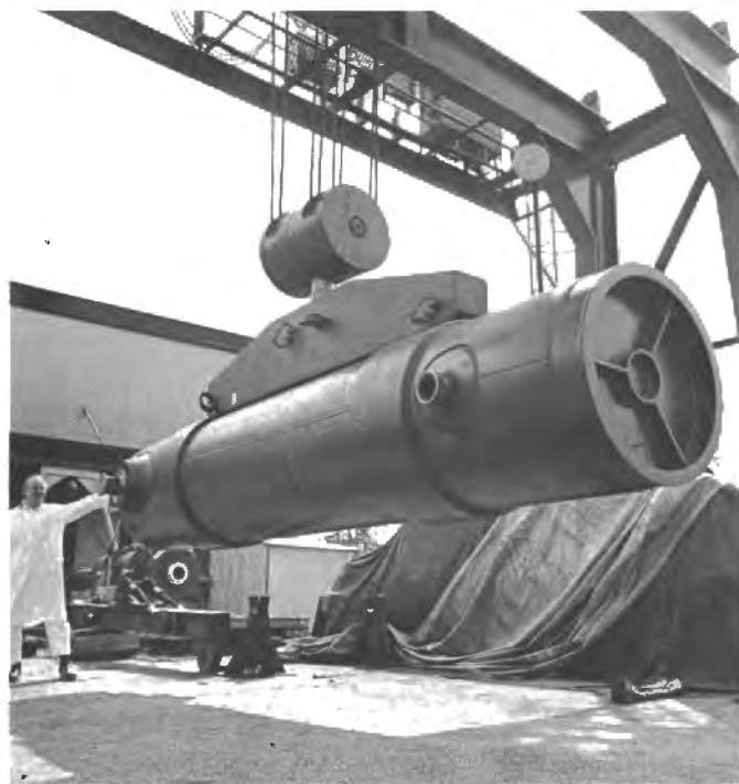
Figur 19. Transportbehållare för använt kärnbränsle. (Från AB Atomenergi, Studsvik.)
