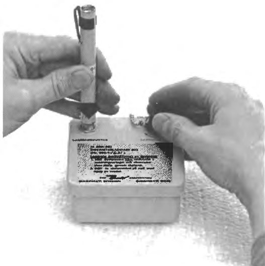
Figur 15 a. Penndosimeter med separat laddningsaggregat.
