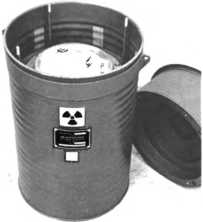
Figur 18. För transport av större mängder radioaktiva ämnen krävs speciella behållare som är goda strålskärmar och tål mekanisk åverkan, s k B-kärl. (Från AB Atomenergi, Studsvik.)
