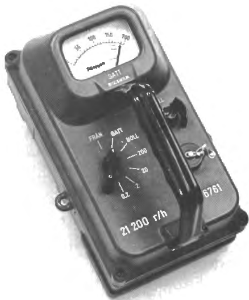
Figur 14. Intensimeter 21. Mätinstrument som anger strålning per tids- enhet.
