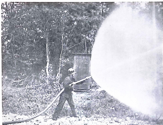
Fig. 2. Stora munstycket. Samma inställning som fig. 1 men med central, slutna stråle inne i skärmen.
