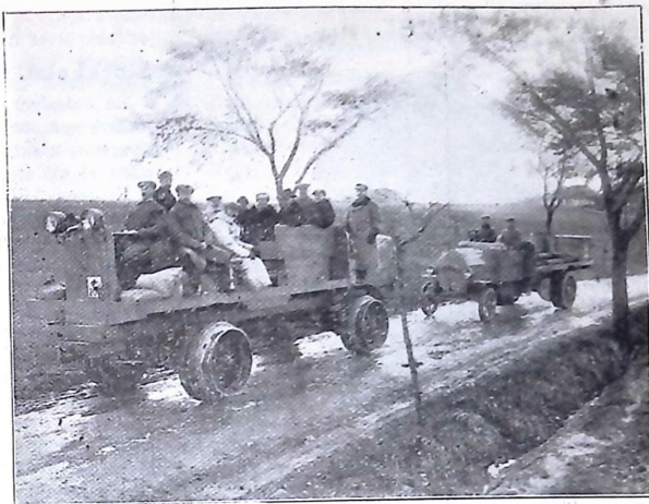
4-tonns Scania-Vabis lastautomobil med 4-hjulsdrift bogserande en 6 tons lastautomobil.
