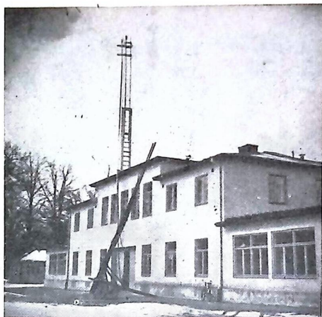
Bild 1. En del av proven utfördes med konstant tryck. För ändamålet användes en 20 m hög ledning genom vilken vattnet trycktes upp. Från mynningen på denna ledning rann det därefter ned genom en annan ledning till bassängen för mätning.
