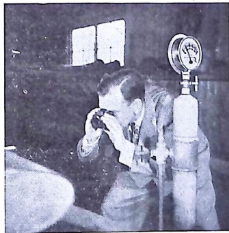
Fig. 2. Avläsning av varvtalet medelst stroboskop.
