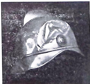
Fig. 2. Den aluminiumhjälm, som vid en tidigare eldsvåda i Mölndal träffats av en nedfallande tegelsten.
