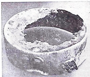
Bild 1. Den delvis nedsmälta botten av kastrullens underdel.
