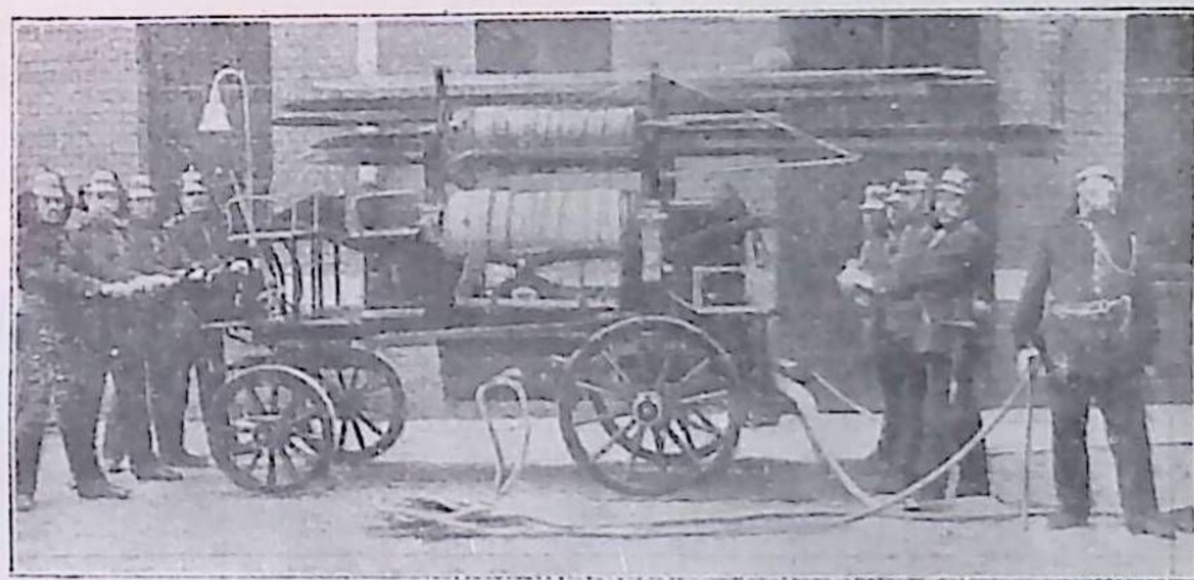
Fig. 13. Tysk gasspruta, handkraftspruta och redskapsvagn, använd som luftpump för rökskyddsapparat.
