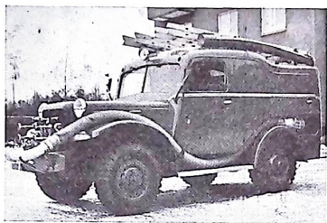
Bild 4. Jeep 1 med inbyggd sugslang, som genom mellandel är fastsatt vid pumpens sugintag. Sugslangen kan utläggas av en man.
