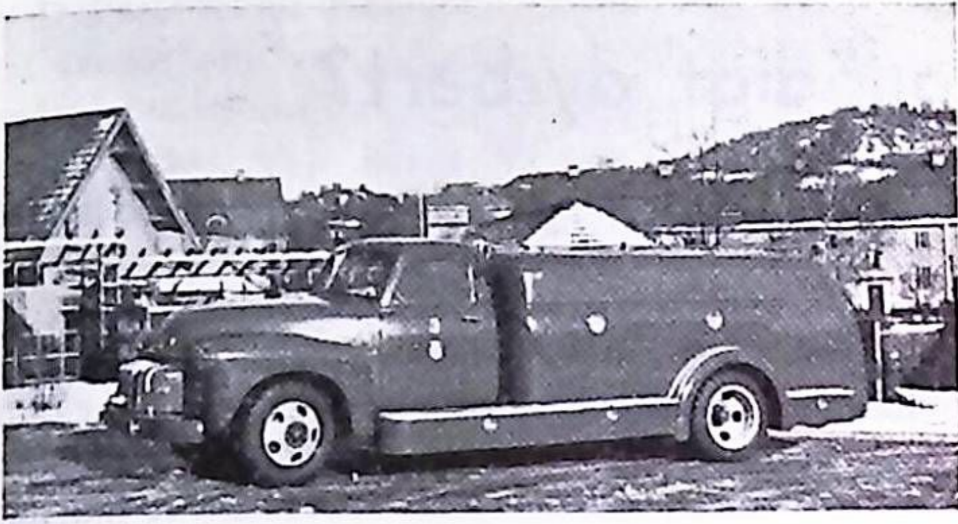
Bild 1. Tankbil för 3000 l. De s. k. fotlådorna bör försvinna. Facken rymmer i övrigt bl. a. ca 400 m 1\frac{1}{2} " slang, 200 l skumvätska, skumrör och annan armatur samt 4 syrgasapparater.
