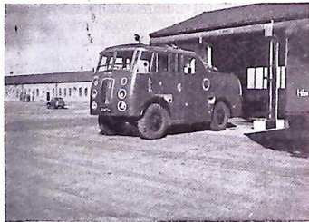
Bild 1. De engelska militära flygplatsernas nyaste haveribrandsbil. Byggt på ett fyrbjulsdrivet T-booby-croftchassi försedd med en 160 hkr Rolls Royce motor. Utrustad med en skumpump producerande 5,75 m 3 skum pr minut och en vattenpump med en kapacitet av c:a 550 l/min. Båda pumparna drivas genom kraftuttag från bilmotorn. Medför c:a 1.800 l. vatten och 270 l. skumvätska samt några mindre handelsläckningsapparater.
