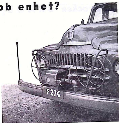
Tempus Frontpump. Kapacitet 200 lit/min vid 7—9 kg/cm 2 tryck.
