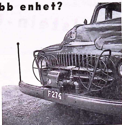
Tempus Frontpump. Kapacitet 200 lit/min vid 7-9 kg/cm 2 tryck.
