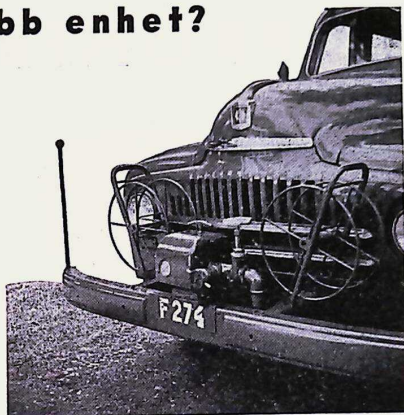
Tempus Frontpump. Kapacitet 200 lit/min vid 7-9 kg/cm 2 tryck.
