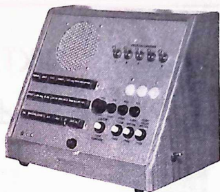
Huvudapparat för "Larm- snabbtelefonanläggning".
