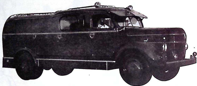
TYP H vattentank 400—3000 lit. 7—12 sittplatser. Efter önskemål. Försänkt tank ger synnerligen goda materielutrymmen.
