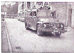
Bild 3. Norrabannars nyförvärv framför brandstationen. Vattentank 2.000 l. Personalbytt för 7 man. Slang 800 m. Pump 2.000 l/min.
