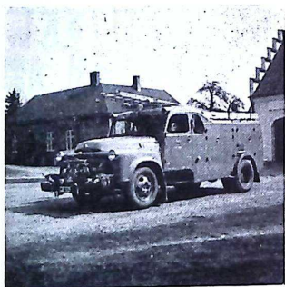
Bild 1. Tankbilen utanför Vellinge brandstation. Vid den frontmonterade pumpen synes rullarna med 38 mm belagd slang med anslutna strålrör av den typ som vid öppnandet först ger spridd stråle och där- efter sluten. — För att göra framkomligheten större har man icke försatt fordonet med fojlådor.
