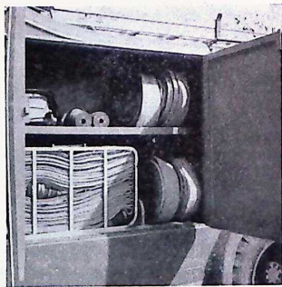
Bild 4. I sidoskåpen finnes slangutrustningen och armaturen. Som synes förvaras grovslangen dels dubbelrullad med ett snöre om rullen dels i slangkorg.
