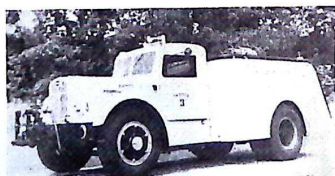
Bild 1. Fyrhjulsdriven tankbil med tank på ca 5000 liter och med frontmonterad pump.
