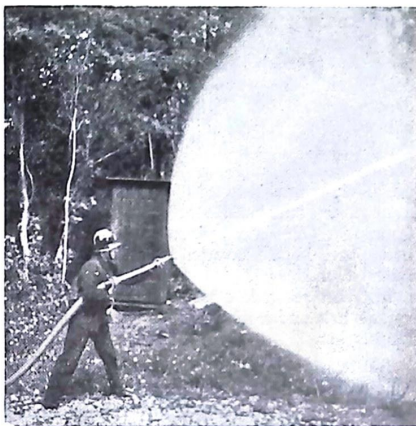
Bild 4. Det stora Mohlin-munstycket med bopfällbar, skärmlänkande, finspridd stråle jämte samtidig centralstråle.
